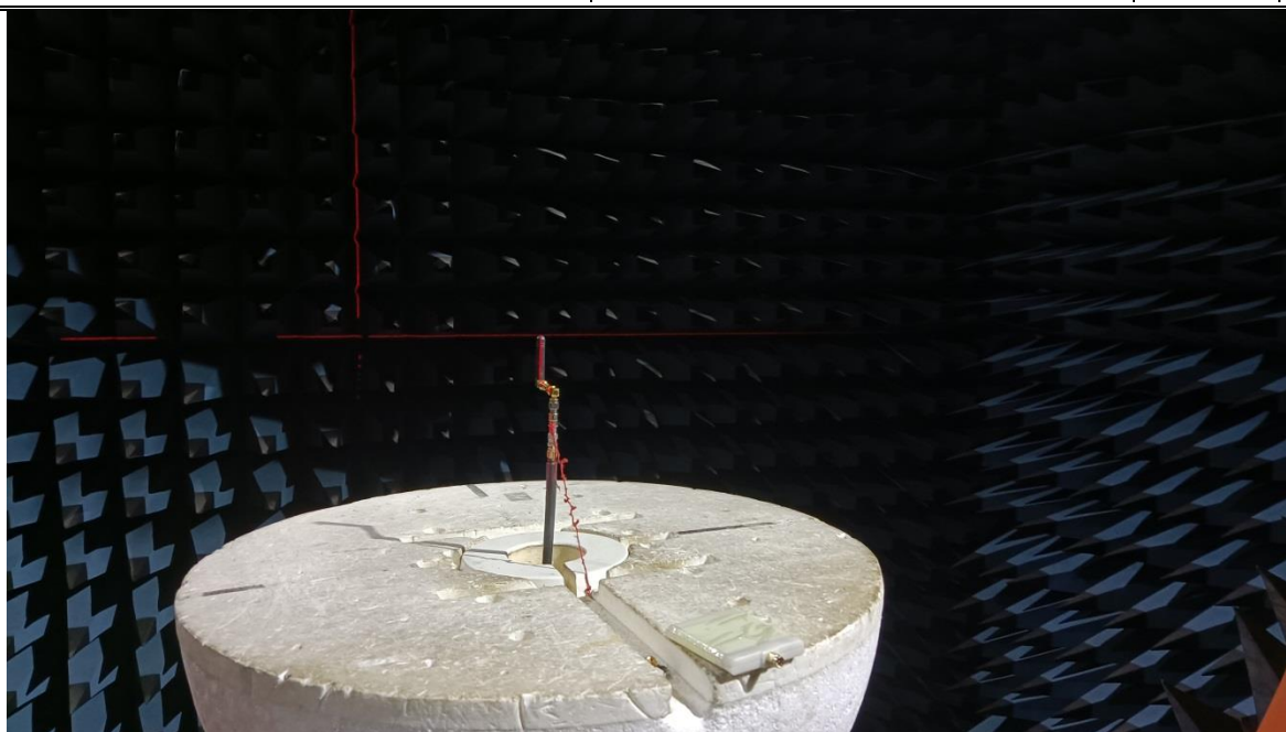
The production test position/天线测试放置位置
